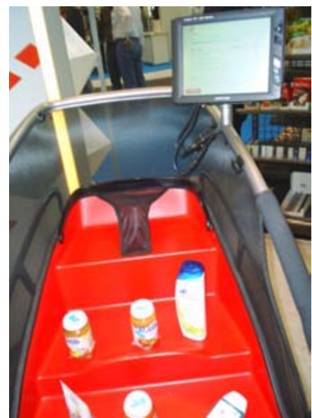
Carrello di supermercato con sistema RFID. Dispone di un display che presenta sia il prezzo dei prodotti in carrello sia la quantità sposta, un appoggio al controllo della spesa. Fotografia del carrello nello stand Retail Institute, alla fiera Interpack a Düsseldorf, Germania, 27 aprile 2008.
