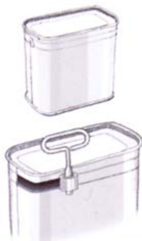
Scatola in acciaio con apertura laterale del 1932, la chiavetta era uno strumento che accompagnava il packaging (Peltier, 2006, p. 13)
